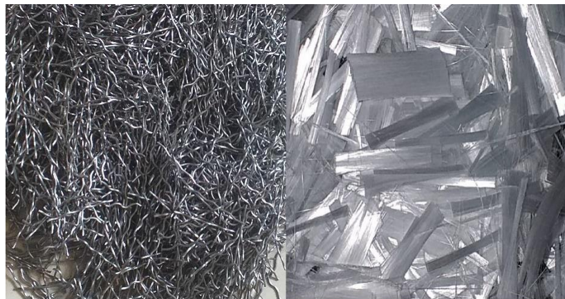
a. Steel fibre
